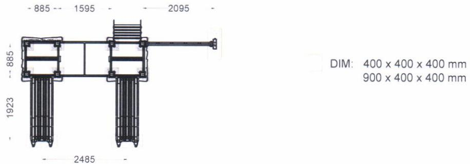
PLANTA . ESQUEMA DE FIXAÇÃO
